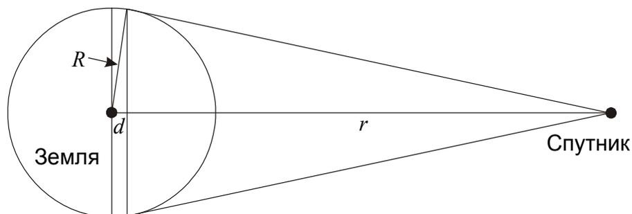
Мы видим, что со спутника будет видно меньше половины поверхности Земли. Кроме задней полусферы, в область невидимости попадет узкая полоса вокруг лимба, которую мы можем считать цилиндрической с радиусом, равным радиусу Земли  $R$  и шириной  $d$ . Из подобия прямоугольных треугольников мы можем записать:
