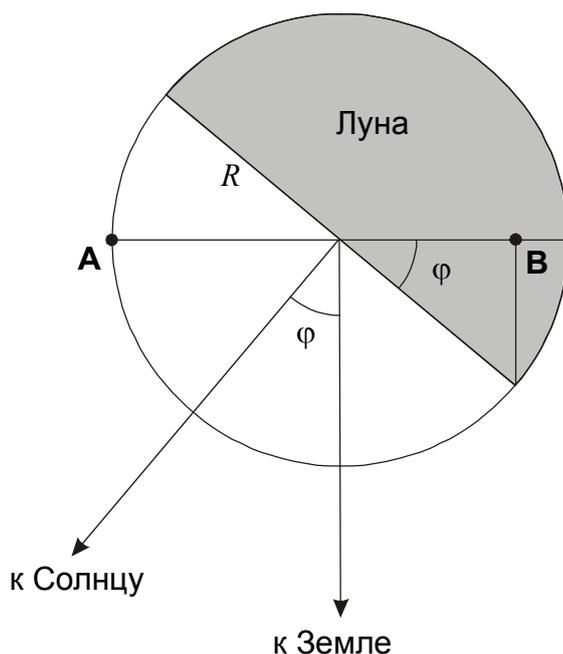
Фаза Луны есть освещенная доля видимого диаметра нашего спутника, лежащего в плоскости, содержащей Солнце, Землю и Луну. Как видно из рисунка, фаза есть отношение длины отрезка **AB** к диаметру Луны. Значение фазы составляет
