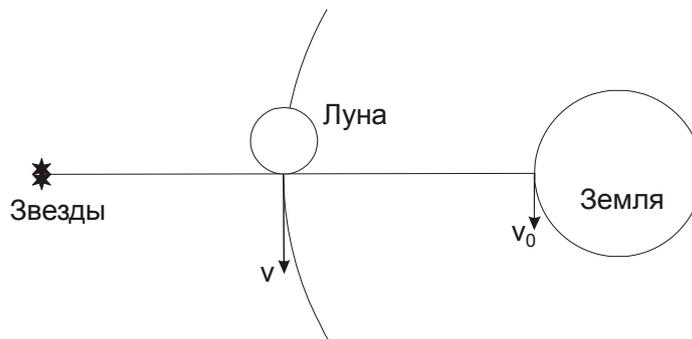
Считая орбиту Луны круговой с радиусом  $L$  и обозначив ее орбитальный период через  $S$ , определим угловую скорость ее перемещения среди звезд на небе:
